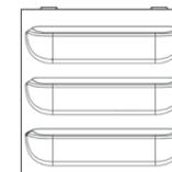
**Kassetten:** Die Kassetten bestehen auf der Vorderseite aus luftdurchlässigem expandiertem Polypropylen (EPP), auf der Rückseite aus Polypropylen (PP) und sind mit einem kapillaren Mikrofaser Tuch aus 80 % Polyester und 20 % Polyamid ausgestattet. Zurückgegebene Kassetten werden in unserer Produktionsstätte mit neuem Tuch versehen und wiederverwendet.
