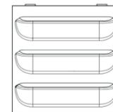
**Kassetten:** Die Kassetten bestehen auf der Vorderseite aus luftdurchlässigem expandiertem Polypropylen (EPP), auf der Rückseite aus Polypropylen (PP) und sind mit einem kapillaren Mikrofaser Tuch aus 80 % Polyester und 20 % Polyamid ausgestattet. Alte und gebrauchte Kassetten werden in unserer Produktionsstätte mit neuem Tuch versehen und wiederverwendet.
