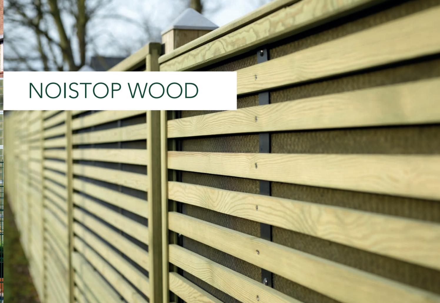
Die NoiStop Wood Elemente bestehen aus einem Steinwollkern, welcher von einem schwarzen PE-Gewebenetz gegen Außeneinflüsse geschützt wird. Die Steinwolle ist durch Aluminiumstreifen und darauf geschraubten, imprägnierten Holzlatten ummantelt.
