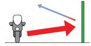
Noistop geluidsscherm: Afscherming én absorptie
