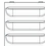
**Kassetten:** Die Kassetten sind auf der Vorderseite aus luftdurchlässigem expandiertem Polypropylen (EPP) gefertigt. Die Rückseite besteht aus Polypropylen (PP). Die Kassetten sind mit einem Kapillartuch versehen, das aus 80 % Polyester und 20 % Polyamid besteht. Alle Materialien können wiederverwendet werden und sind vollständig recycelbar.
